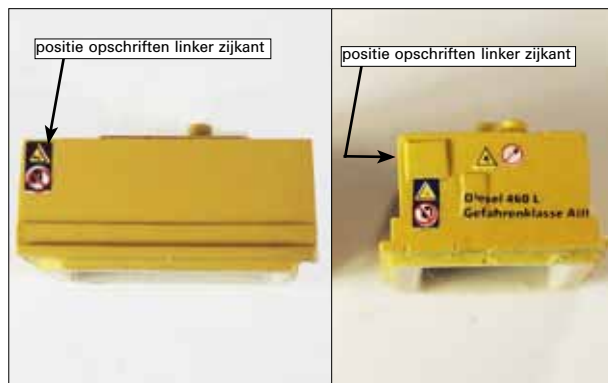
Foto 32: Plaatsing opschriften linker zijkant dieselolietank
